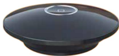
**Hub Idehome Idrm:** Se trata del núcleo del sistema Idehome, que sirve de enlace entre las persianas (u otros dispositivos compatibles) y la app Idehome instalada en el smartphone/tablet.
